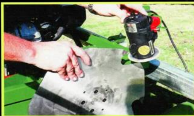
MINI-AFFÛTEUSE 12 VOLTS POUR PERMETTRE D'AFFÛTER RAPIDEMENT ET FACILEMENT LES LAMES
