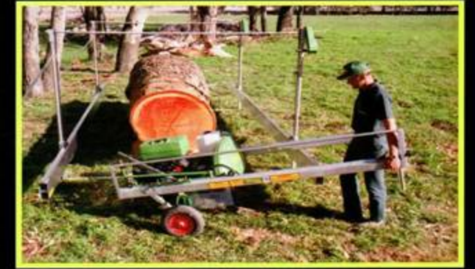
ROUES DÉMONTABLES FIXÉES SUR LA TÊTE MOTRICE POUR FACILITER LE DÉPLACEMENT
