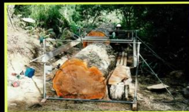
CADRE AJUSTABLE POUR COUPES PARALLÈLES AU FIL DU BOIS
