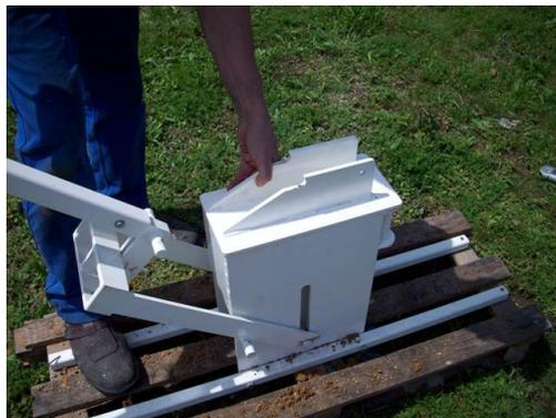
7 - MONTER LE LEVIER JUSQU'À LA BUTÉE (DE L'APPUI)
